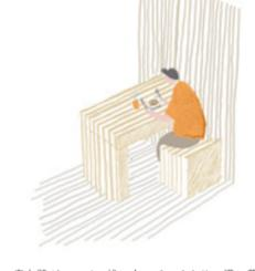
床と壁がルーバー状になっているため、溝に差し込むように家具もルーバー状に構成した。より自然に抜けた印象になる。
