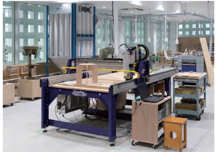
木工室（パネルソー、スライドソー、CNCルーターShopBot他、木工用機器・機材を装備）
