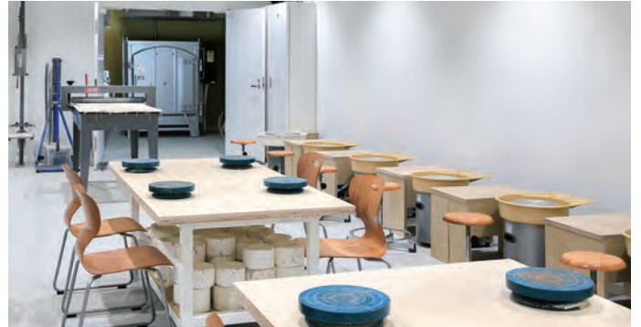
陶芸室・石膏室（大小3基のマイコン制御の電気窯、電動ろくろ、真空式土練機、たたら機他、陶芸・石膏制作のための機器・機材を装備）
